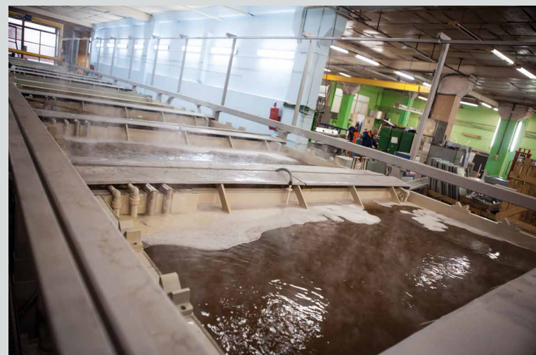
Автоматическая линия химической очистки металла, завод "Айсберг"Лтд., Одесса Automatic line of chemical metal purification, "Aisberg" Ltd factory, Odessa, Ukraine
