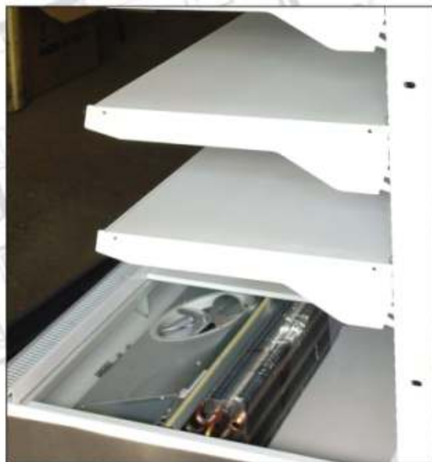
Испаритель пристенной витрины европейского производства
